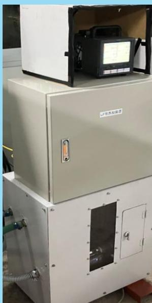
★ **ウルトラファインバブル**を用いることで、炭酸ガスの比表面積増大により溶解効率を改善し、高pH水中和時のロスを削減することが可能。
