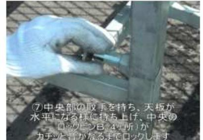
⑦中央部の取手を持ち、天板が水平になる様に持ち上げ、中央のロックピンB(4ヶ所)がカチッと音がなるまでロックします
