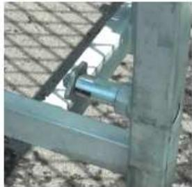
⑥天板を持ち上げ可動脚部のロックピンA(4ヶ所)を引いて所定の高さに合わせカチッと音がなるまでロックします
