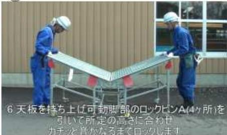
⑥天板を持ち上げ可動脚部のロックピンA(4ヶ所)を引いて所定の高さに合わせカチッと音がなるまでロックします
