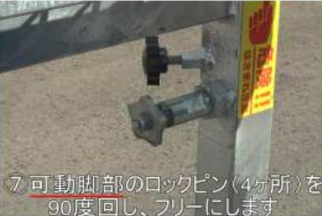
⑦ 可動脚部のロックピン(4ヶ所)を90度回し、フリーにします
