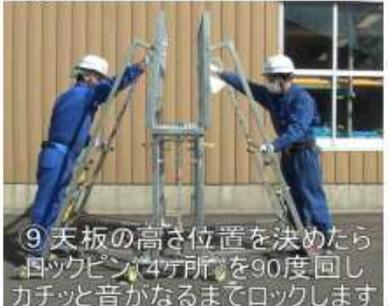
⑨ 天板の高さ位置を決めたらロックピン(4ヶ所)を90度回しカチッと音がるまでロックします
