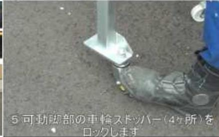
⑤ 可動脚部の車輪ストッパー(4ヶ所)をロックします
