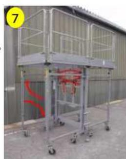
○安定バーを矢印の方向に展開しロックピンで固定。
