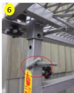
○天板を持ち上げて外脚内管上部から2番目の穴位置にロックピンを差し込む(4カ所)
