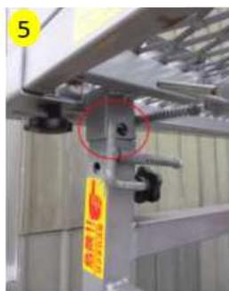
○外脚内管と天板の内管受けをロックピンで固定(4カ所)
