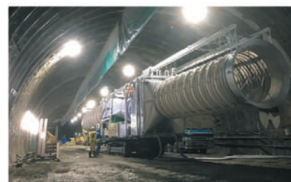
ECステーション M-ECS3000型 (M-ECXV3000搭載機) 自走式走行台車装置付 伸縮ダクト付 全伸縮長 15~30m
