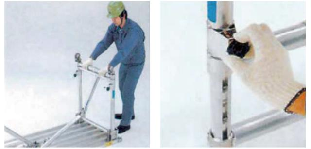
本体の脚柱は起こすだけで自動ロックされます。高さ調節は作業床を持ち上げ安全ロックを回すだけで可能です。
