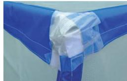
シートの構造上、角部などは隙間が発生します。
