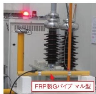
耐電圧試験 (JIS規格C4510)
